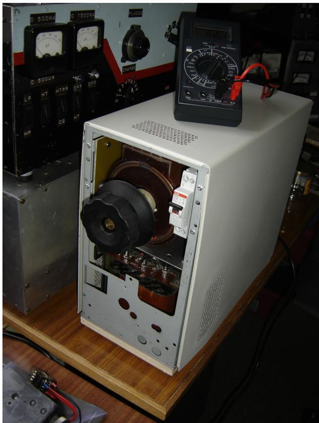
La face avant a été posée après déplacement du disjoncteur à l'intérieur du coffret
