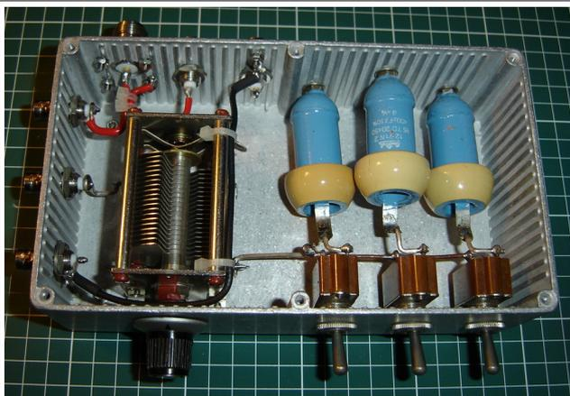
Bande 80 m (3600 Khz) - Charge antenne :
