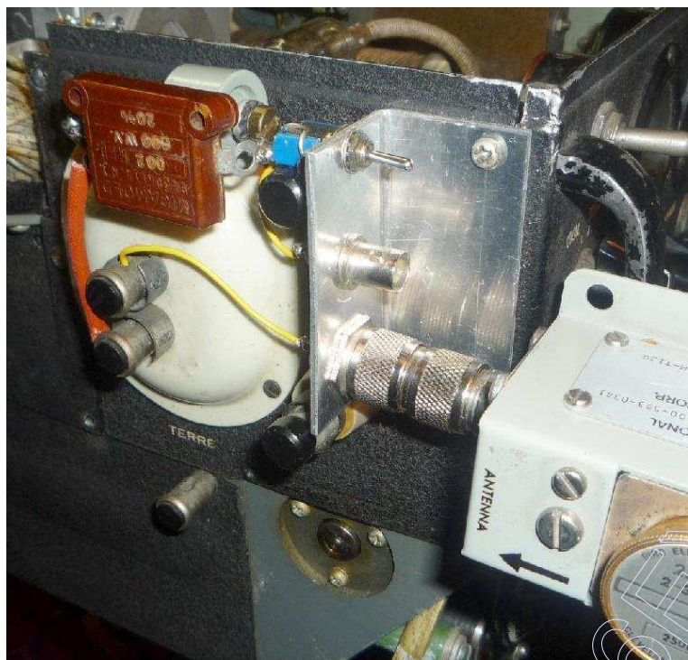
Figure 4.1 ci contre montre l'assemblage des deux condensateurs supplémentaires et le commutateur à 3 positions (avec une position neutre au centre) qui les commutent lorsque nécessaire. Le commutateur est monté sur un support en L sur lequel sont également installés un socle SO-239 pour l'antenne et une fiche BNC pour l'antenne du récepteur. Le premier est connecté à la sortie A de l'ART-13 et le second à la sortie E de la figure 2.2.
