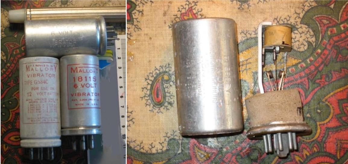
**Des vibreurs mécaniques anciens. Vibreur ouvert. On peut observer la palette vibrante au centre et les deux contacts de chaque côté.**
