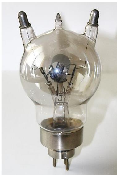
Fig. 1. La triode d'émission METAL E4M de 40W
