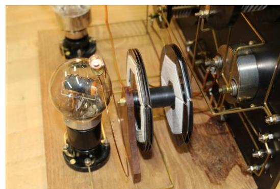
Fig. 15. Boucle de couplage en substitution de l'ondemètre
