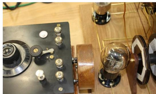
Fig. 13. Mesure au niveau de la self oscillatrice
