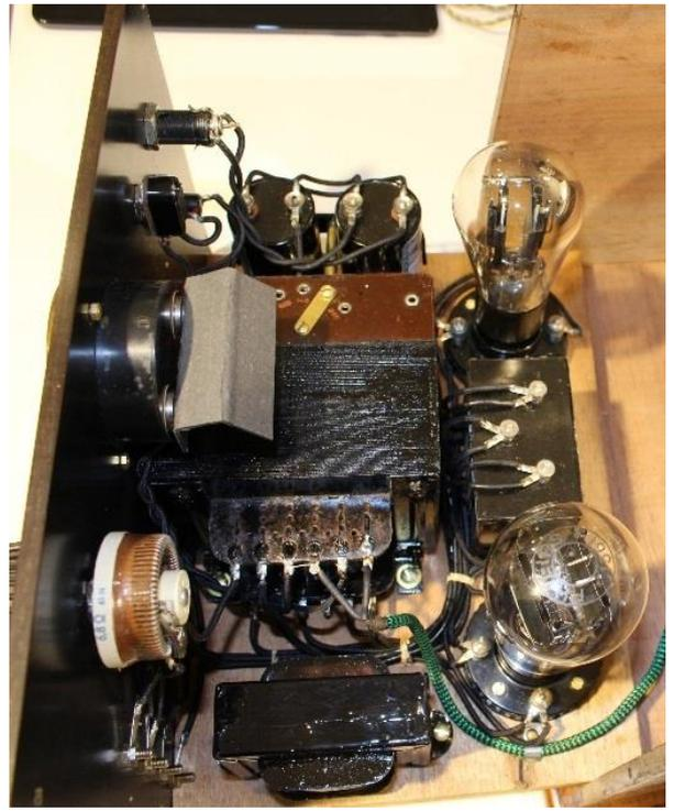
Fig. 10. Intérieur du boîtier d'alimentation
