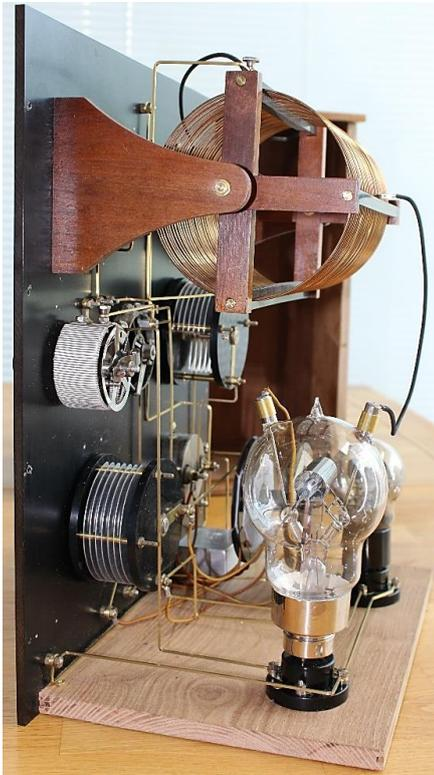
Fig. 6. L'imposante self sur laquelle sont disposées les pinces de réglage d'antenne et d'anode
