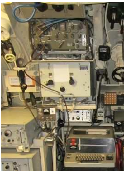
Une vue d'un ER94B en PC radio, photo prise dans le sous marin « Flore » en présentation à Lorient.
