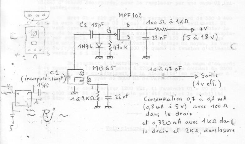
Le problème, très répandu de nos jours, est de pouvoir limiter la tension d'alimentation d'un petit émetteur-récepteur (par exemple monté sur un véhicule automobile alimenté - 'très généreusement - par un alternateur.
